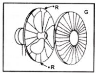
Acople la rejilla de protección (A) al perno central (B), de tal manera que los telones (C) se inserten en los agujeros del centro de la rejilla, y asegurese ésta mediante la tuerca abierta de ajuste (D). Inserte la hélice (E) en el perno (B), controlando que el cañito (F) coincida con las cavidades de la hélice y asegure luego con tuerca ciega (F) en sentido antihorario. A continuación, fije la mitad delantera de la rejilla de protección (G) por intermedio de las trabas. Coloquelas a mano.
